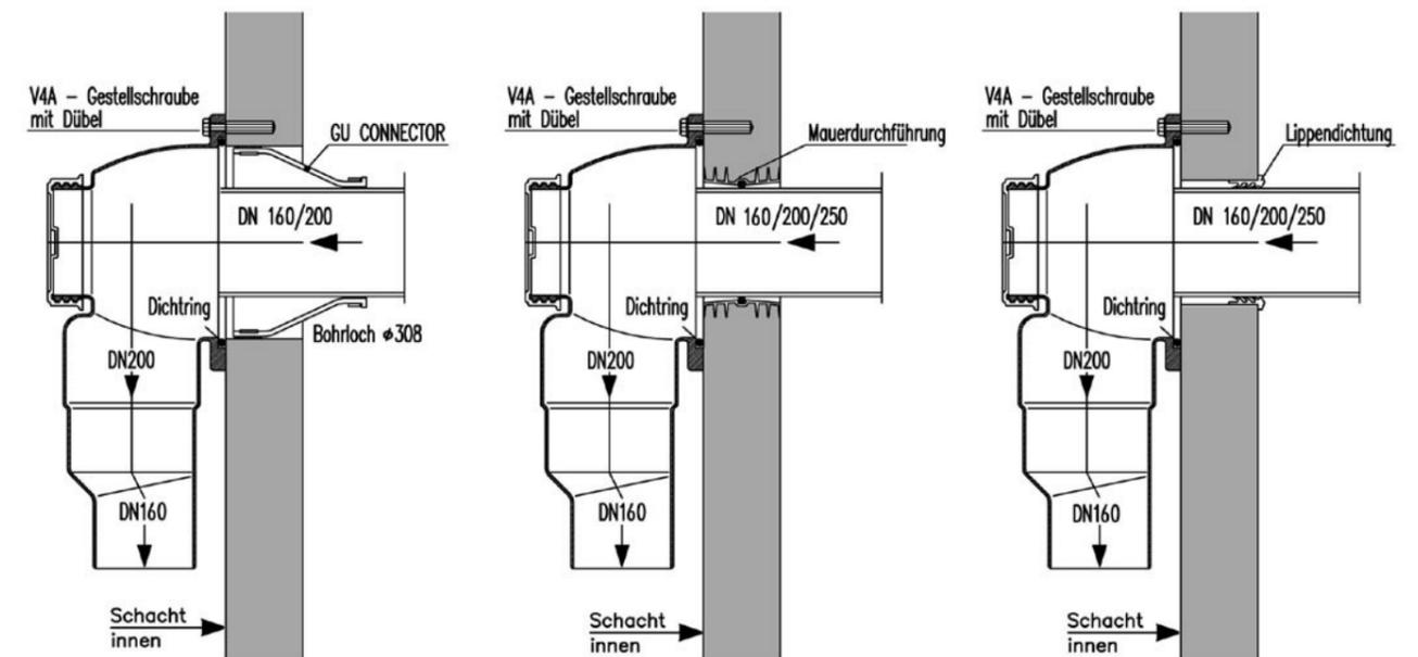
Herstellen der Anschlußöffnung (Bohrlochdurchmesser 308 mm), werkseits oder bauseits, einschließlich Liefern und Versetzen einer 10mm dicken Gummi-manschette (GU Connector der Fa. GU Liner Systems oder Gleichwertiges) zur Erzielung einer universellen Anschlußmöglichkeit und dichte Verbindung mit dem anzuschließenden Rohr DN 160/ 200 herstellen.
